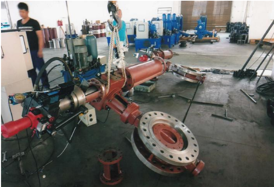
电液（伺服阀）调节蝶阀---带快关外形图（弹簧蓄能）
